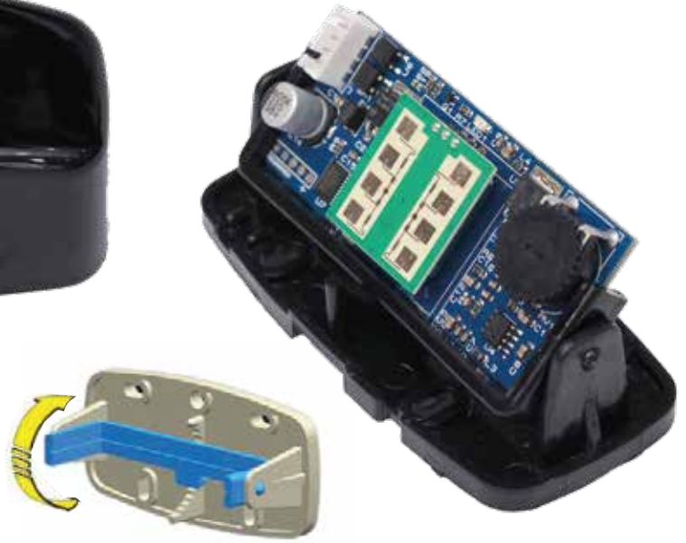
Şekil 2 : Algılama Açısının Ayarlanması Figure 2: Calibration Angle Adjustment
